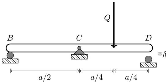
Por lo cual antes de tocar el apoyo D se puede resolver de forma isostática:
