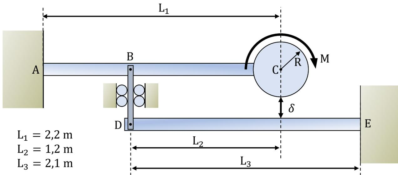
**Problema 2.– (2.0 Pts.)** La viga AB perteneciente a una estructura diseñada por la empresa a la cual usted trabaja no ha sido capaz de soportar la carga centrada de 14,45kN (como se muestra en la figura). Para realizar el cambio de la viga usted cuenta con una viga de la misma longitud con un perfil W200x15 de acero SAE 1020 ( $\sigma_y = 210$  MPa). Además cuenta con los siguientes materiales:
