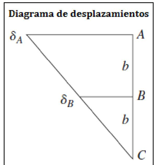
Si se analiza el caso en que el alambre B se suelta se tiene que  $T_B = 0$ , así las ecuaciones 1 y 5 resultan:
