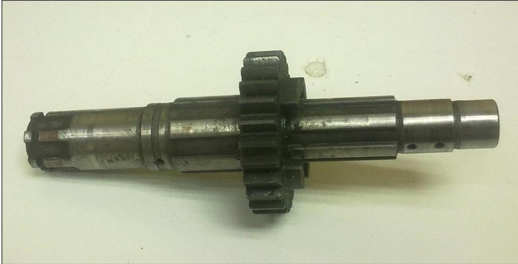
Para el caso de la pieza 2 se debe diseñar un engrane que encaje en las ranuras del eje y en las ranuras que salen del piñon móvil que trae el eje modelado.
