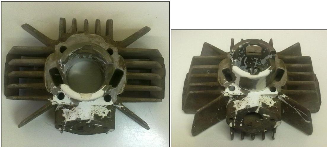
Para el caso de la pieza 1, que corresponde a una parte de un motor de 2 tiempos de motocicleta, se debe diseñar un pistón que encaje en la pieza modelada.
