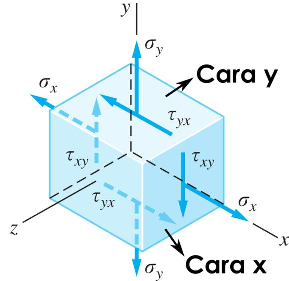
El esfuerzo sobre una **superficie** se obtiene dividiendo la fuerza entre el área en la que actúa. El **esfuerzo en un punto** corresponde al *esfuerzo medio* uniformemente distribuido sobre un elemento diferencial de área.
