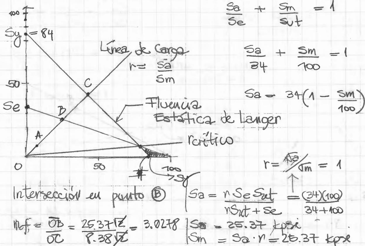
La zona "achurada" ≠ muestra que usando un criterio estático (falla de primer ciclo) basado en la fluencia ( $S_y$ ) podrá controlar el diseño.
