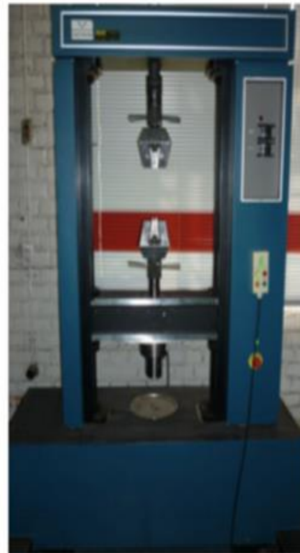
Máquina INSTRON Cap. máx. 100kN
