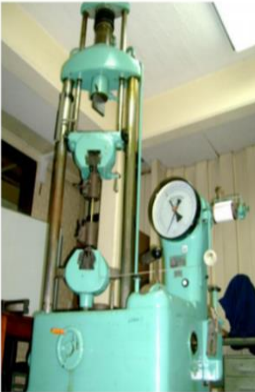
Máquina LOSENHAUSENWERK Cap. máx. 100kN
