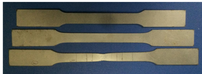
Probetas típicas del ensayo, normalizadas (ASTM) ( dogbone )
